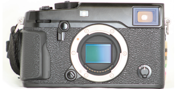
Resim 4. Sayısal fotoğraf makinesi algılayıcısı (Dr. Tamer Akça'nın arşivinden).
