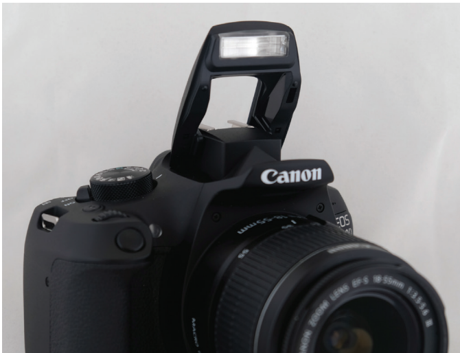
Resim 7. Fotoğraf makinesi gövdesi ile bütünleşik flaş (Dr. Tamer Akça'nın arşivinden).
